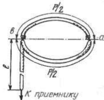
Выполнена антенна из двух отрезков однотипного 50- или 75-омного коаксиального кабеля длиной  $\frac{P}{2}$  и  $\left(\frac{P}{2} + l\right)$ . Оплетка и центральный провод на концах дальнего (по схеме) отрезка спаяны вместе и в точке *a* припаяны к центральному
